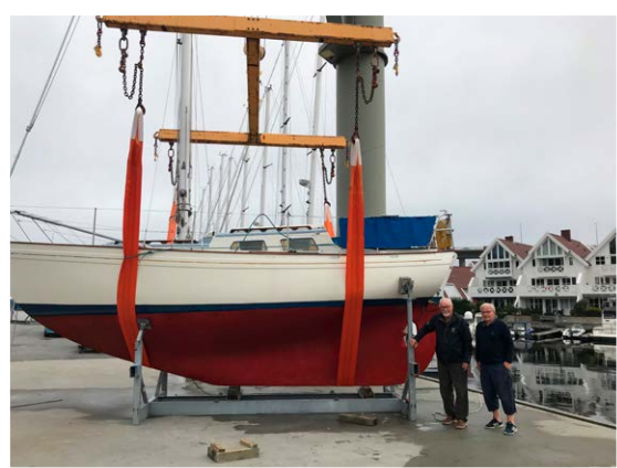
Langkjølte båter stiller andre krav til hvor løftestroppene plasseres. Foto: Lars Ole Gudevang.
