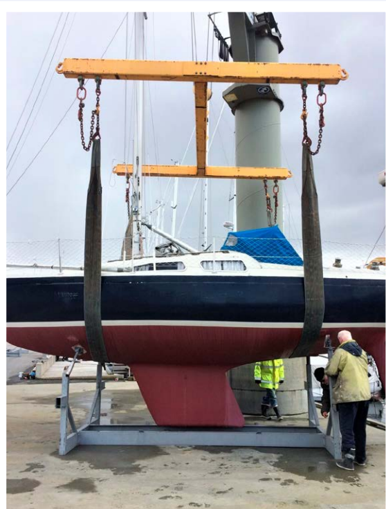
Mindre båter løftes med løftestroppene lenger inn på løfteaket. Foto: Carsten Bowitz.
