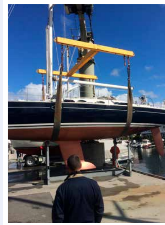
Det er mange ulike båter i havnen. Bilde her viser en større båt med dyp finnekjøl der løfestroppene er satt ytterst på løfteåket for å oppnå best balanse. Foto: Carsten Bowitz.
