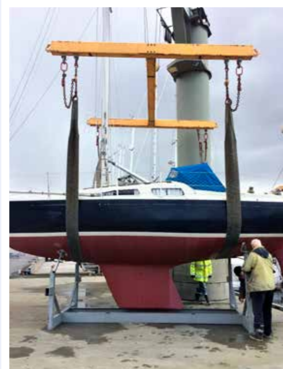
Mindre båter løftes med løftestroppene lenger inn på løfteaket. Foto: Carsten Bowitz.
