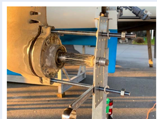
Figur 3: Demontering av lagerhus og aksling med hjemmelaget avdrager.
