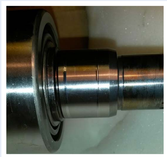
Figur 6: Slitasje i selve akselen etter pakninger.
