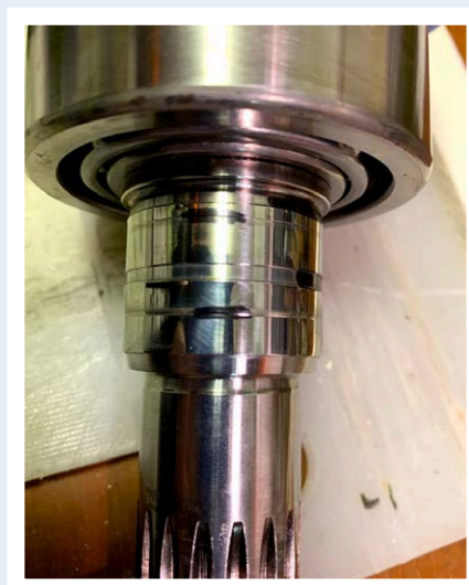
Figur 9: Selv «speedi-sleeve» blir slitt: tydelige spor etter ca. 3 år.
