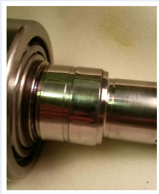
Figur 8: Utbedring ved installasjon av «speedi-sleeve». Monteringsflens er fjernet.
