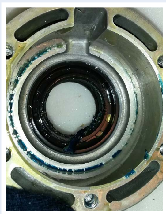
Figur 5: Lagerhus med pakningsringer (en mot sjø og en inn mot drev).
