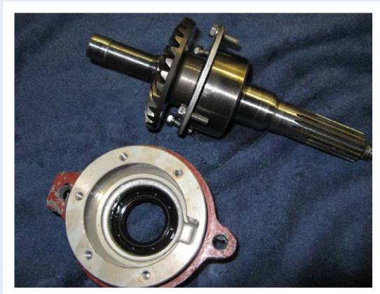
Figur 4: Aksel og lager - tatt ut av lagerhus.
